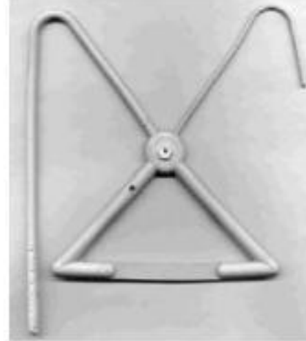
Resim 12: Karışım 1'in kalıp kirlenme derecesi, Permalease 90'la kaplanmış kalıp
