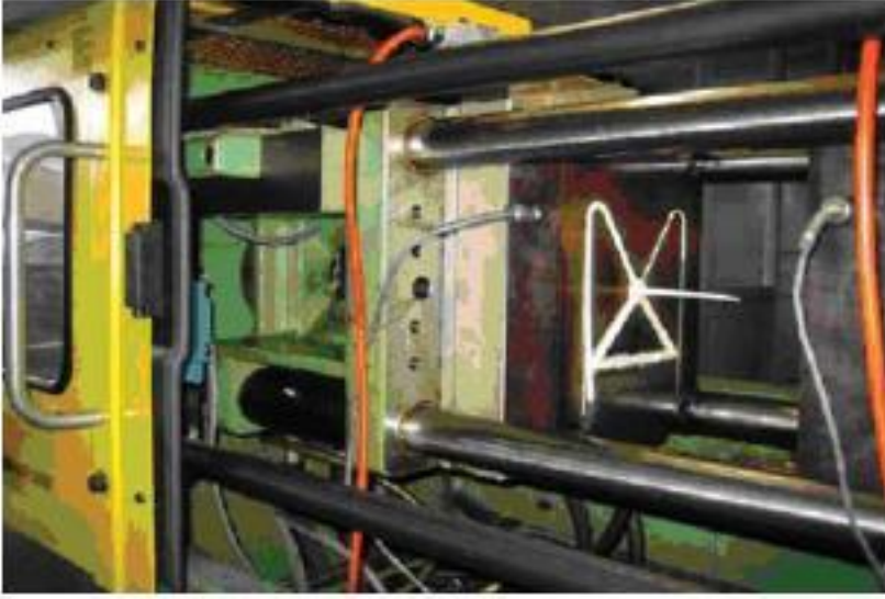
Resim 10: Kalıp temizleme karışımının enjeksiyonlanmasından sonra örümcek kalıbın durumu
