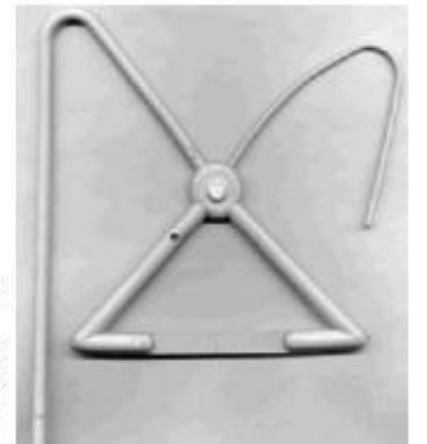
Resim 14: Karışım 2'nin kalıp kirlenme derecesi, Permalease 90'la kaplanmış kalıp
