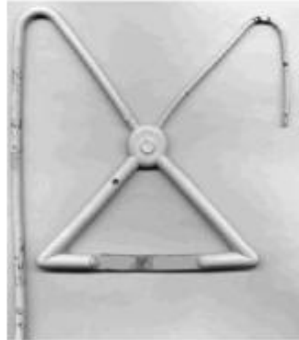
Resim 11: Karışım 1'in kalıp kirlenme derecesi, kaplanmamış kalıp
