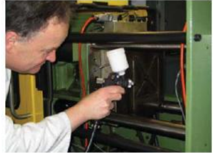
Resim 6: Yarı kalıcı kalıp ayırıcıyla örümcek kalıbın hazırlanması
