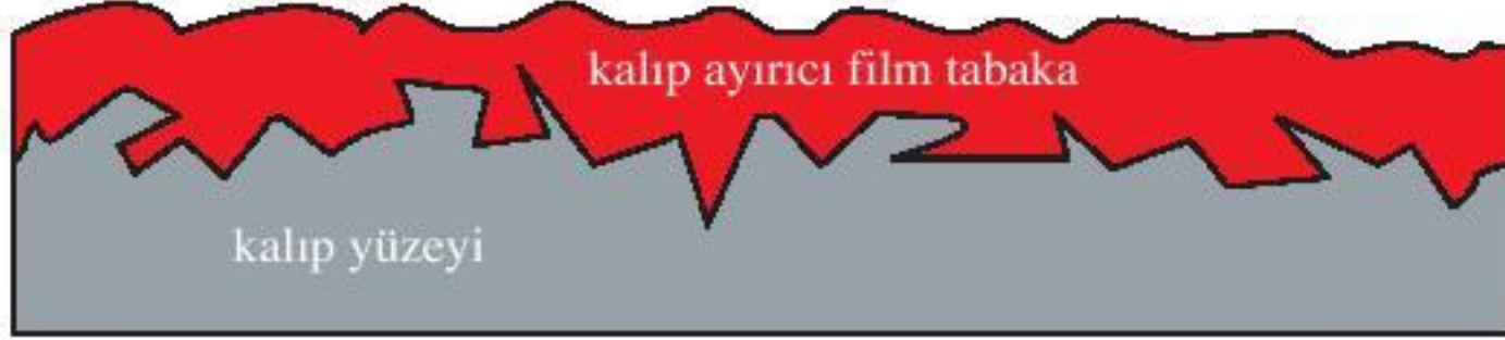
Şekil 1: Kalıp ayırıcıyla kaplanmış kalıp yüzeyi
