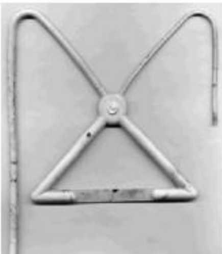
Resim 13: Karışım 2'nin kalıp kirlenme derecesi, kaplanmamış kalıp
