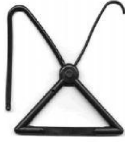
Resim 9: Karışım 2'nin örümcek enjeksiyonlaması, kaplanmış kalıp
