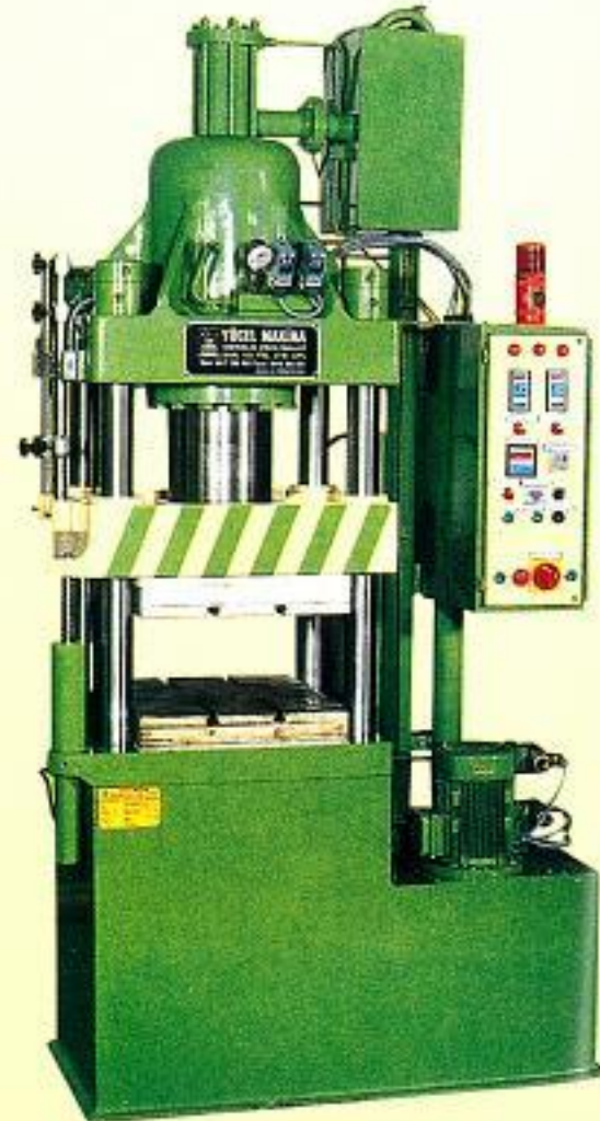
HLP 110 Ton Otomatik gaz atmali hidrolik lastik presi
