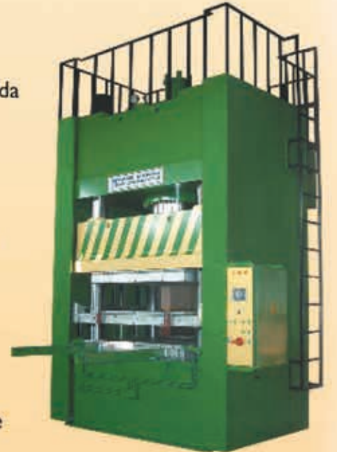
HLP 1000 Ton Kalıp sürücülü hidrolik lastik presi
