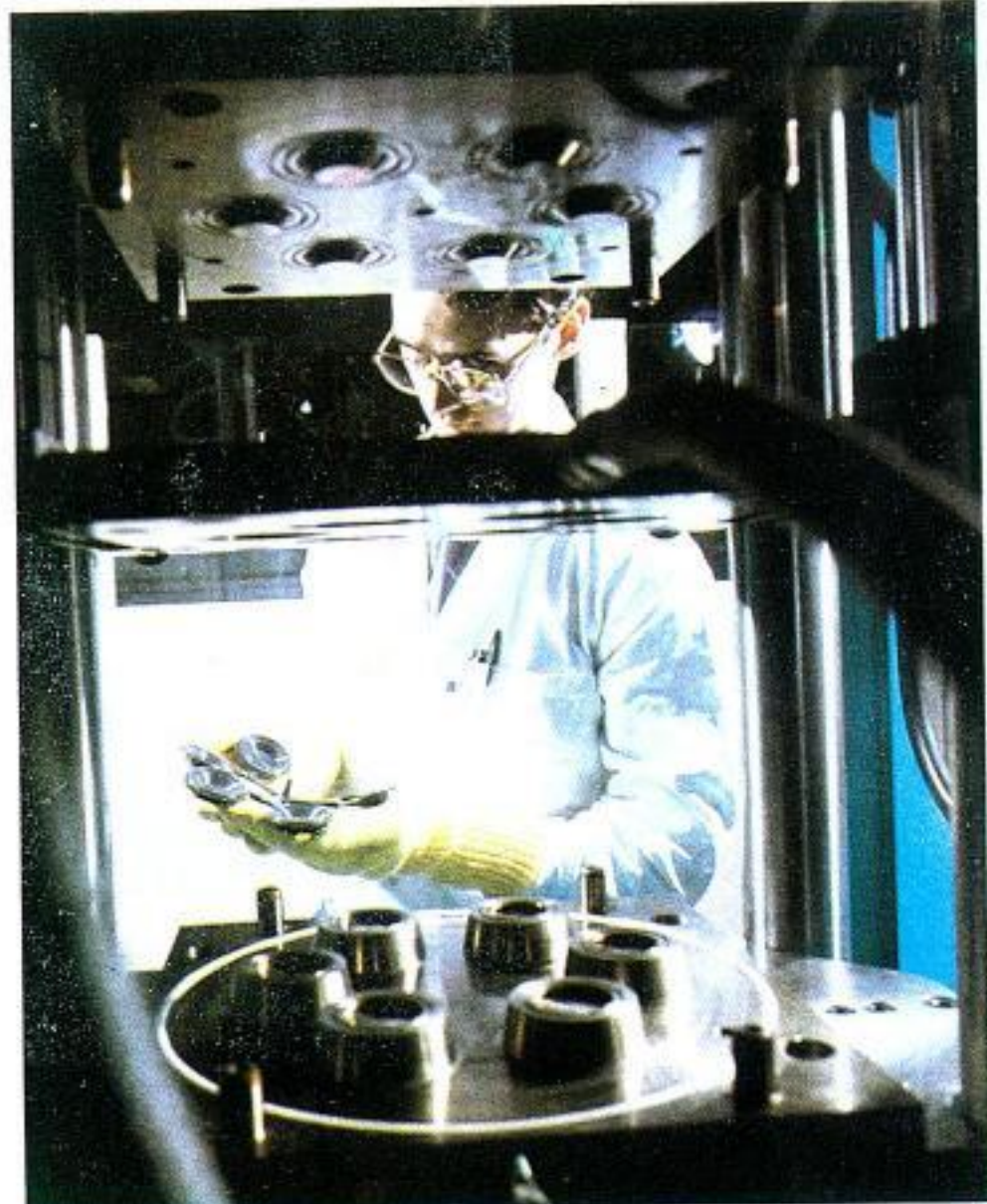
Altı gözlü bir kalıptan mamulü çıkarmak işlemi
