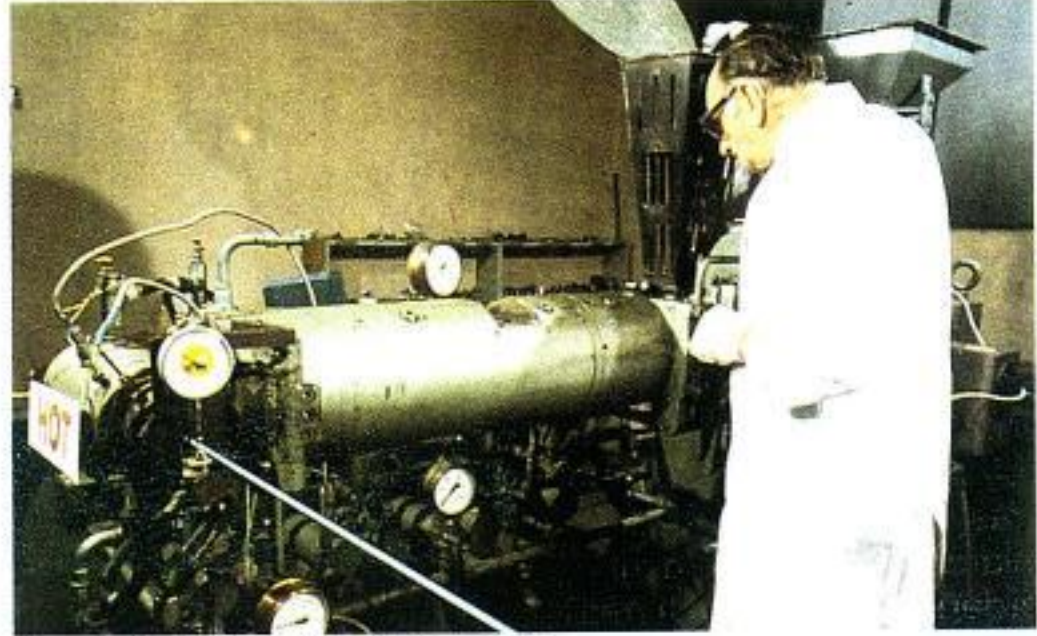
Yan kafalı bir ekstruderde kablo izolasyonu çekimi.
