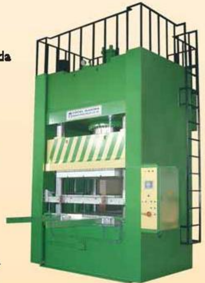
HLP 1000 Ton Kalıp sürücülü hidrolik lastik presi
