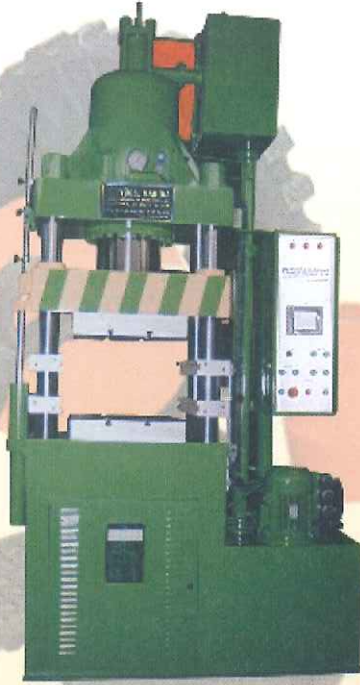
HLP 250/20+20 Ton 2 ve 3 parçalı kalıplarla çalışmak için 2 maçalı çok amaçlı hidrolik lastik presi
